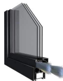
© Deceuninck - Elegant is uitgerust met ThermoFibra glasvezeltechnologie en een Forthex versterking in pvc hardschuim: een energie-efficiënt raamsysteem zonder staalversterking!
