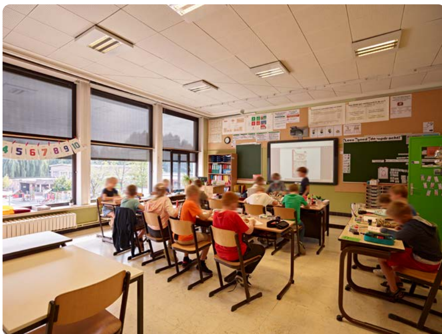
Screens zijn een must om de temperatuur in de klassen onder controle te houden
